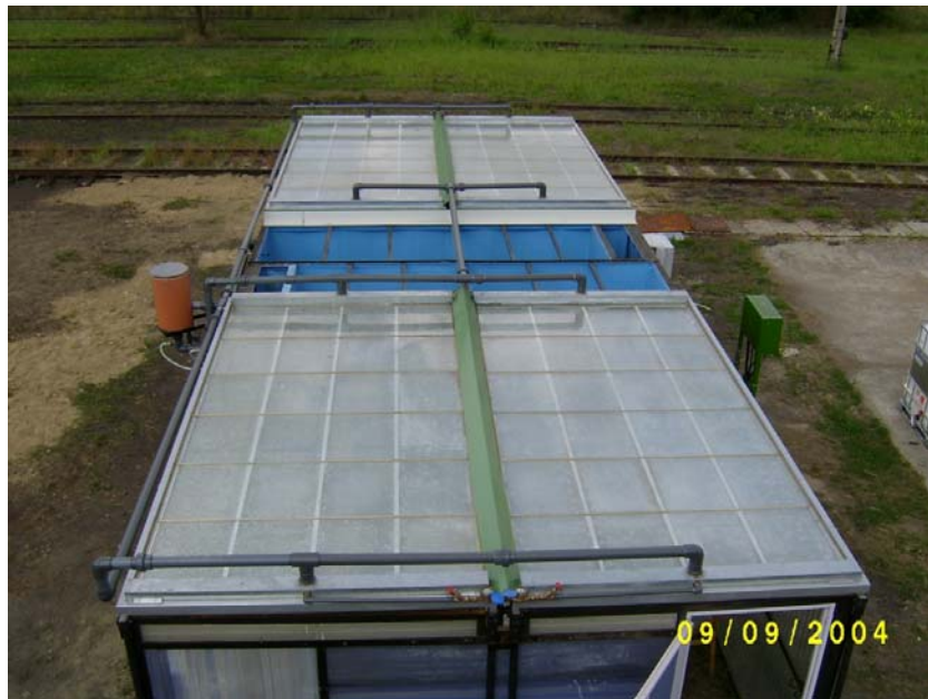
Klór-benzolokkal szennyezett talajvíz tisztítására szolgáló reaktor
