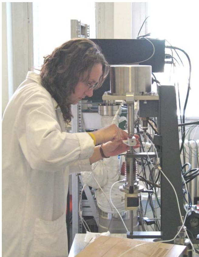
Minta behelyezése a TG-MS rendszerbe
