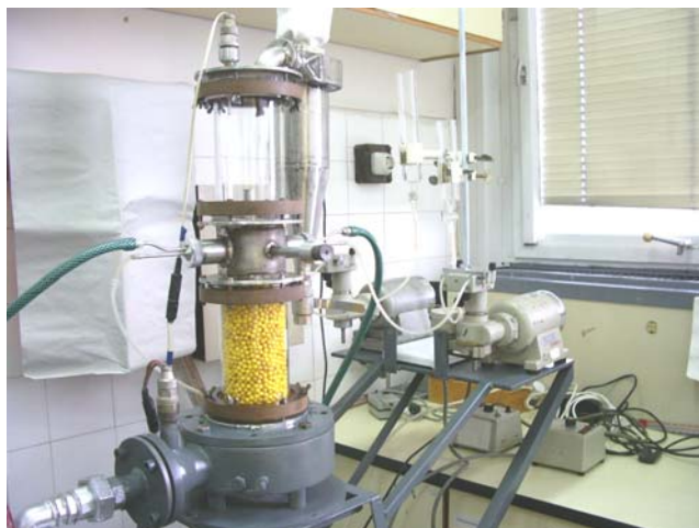
Mechanikus gejszárító inert töltettel
