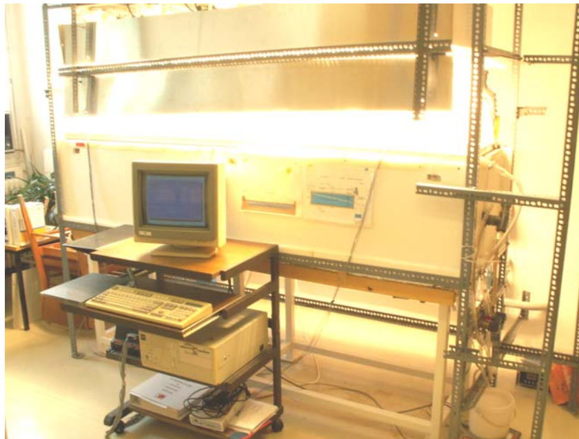
Laboratóriumi méretű napenergiás desztilláló egység
